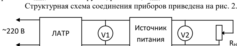
Рис. 2. Структурная схема соединения приборов для определения уровня пульсаций выходного напряжения.
